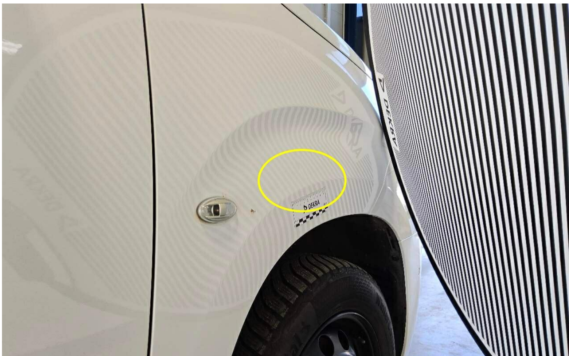
Bild 20 : Kotflügel rechts, eingedellt
