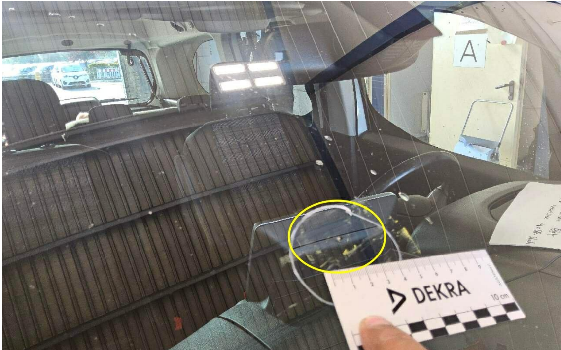
Bild 15 : Frontscheibe Steinschläge im Sichtbereich
