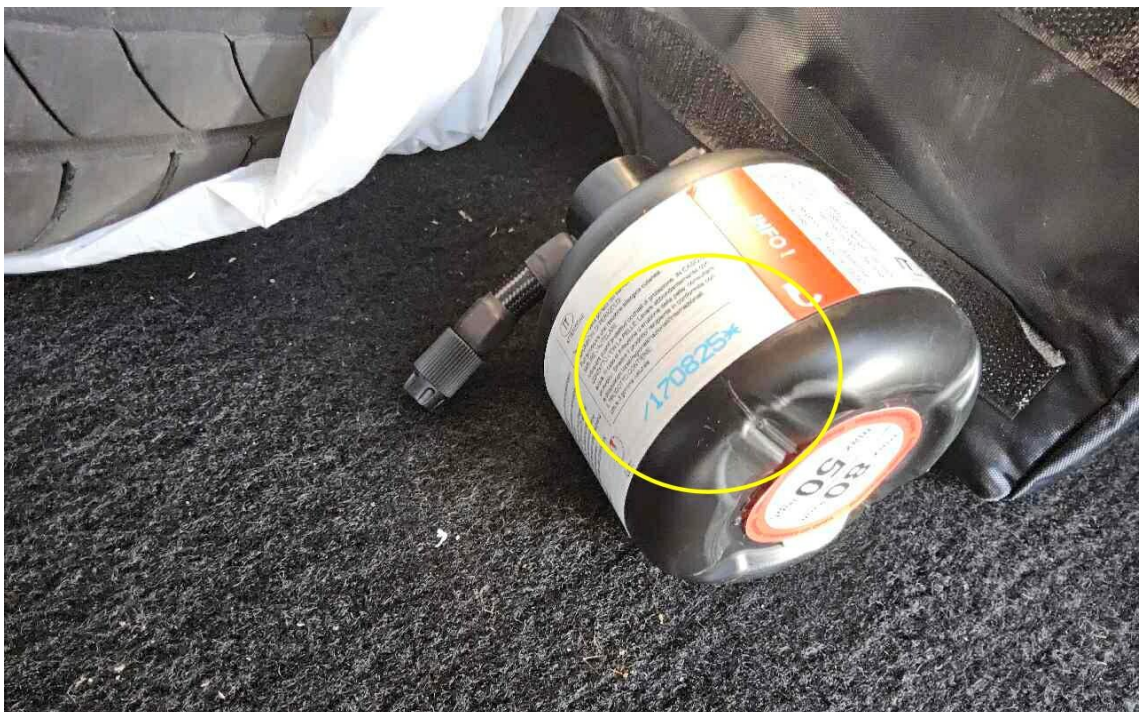
Bild 10 : Reifenfüllflasche (Tirefit), abgelaufen
