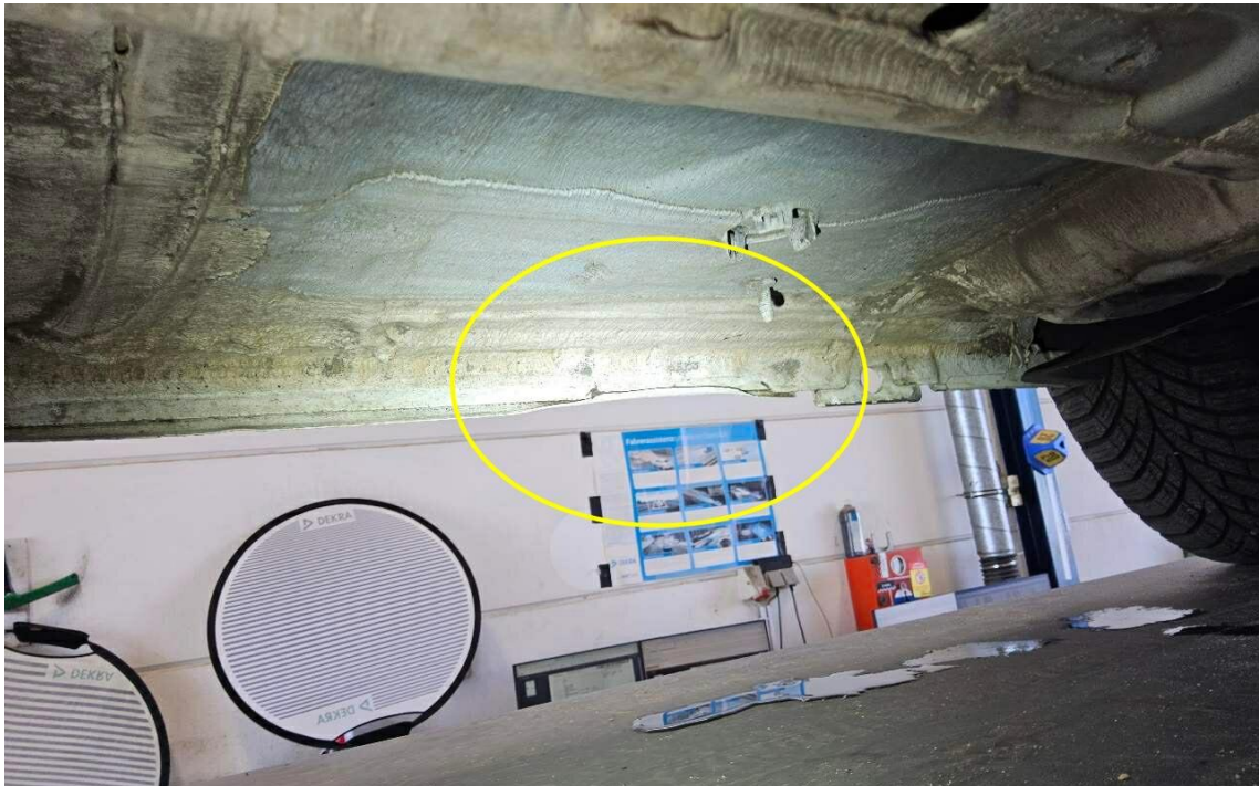
Bild 21 : Schweller links, Kante verformt
