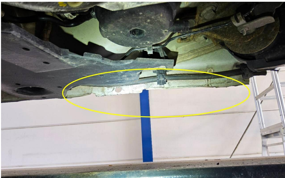
Bild 22 : Schweller rechts, Kante verformt
