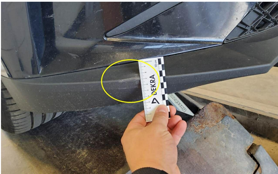
Bild 16 : Stoßfänger vorne, Frontspoiler verschrammt
