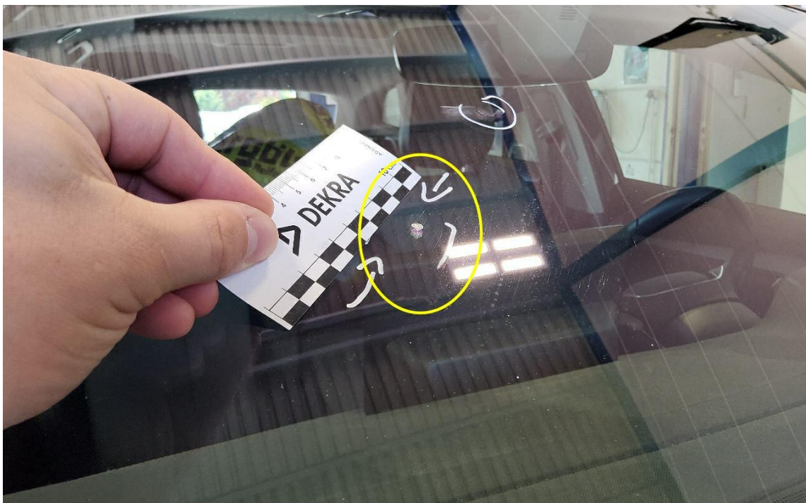
Bild 12 : Frontscheibe, Steinschläge mit Rissbildung
