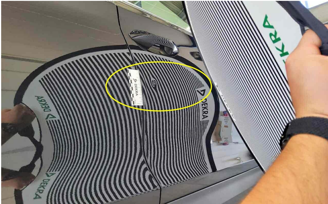
Bild 15 : Tür vorne rechts, eingedellt
