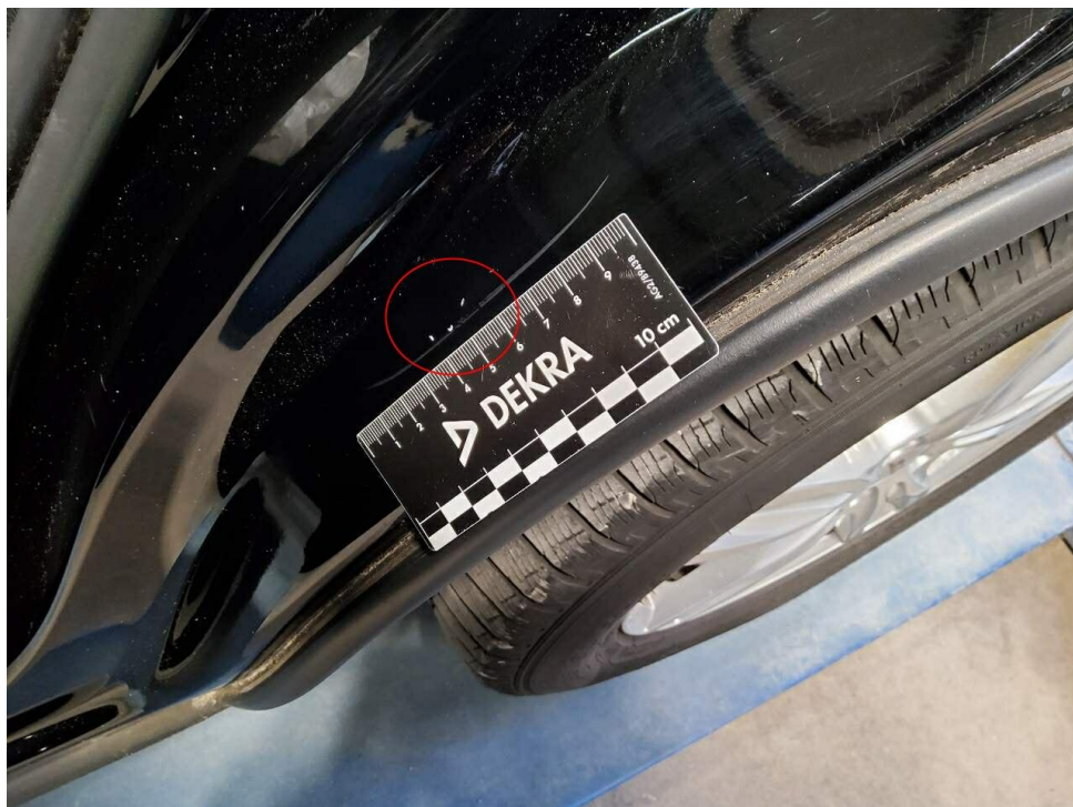
Bild 8 : Tür hinten links Einstieg Lackierung, zerkratzt
