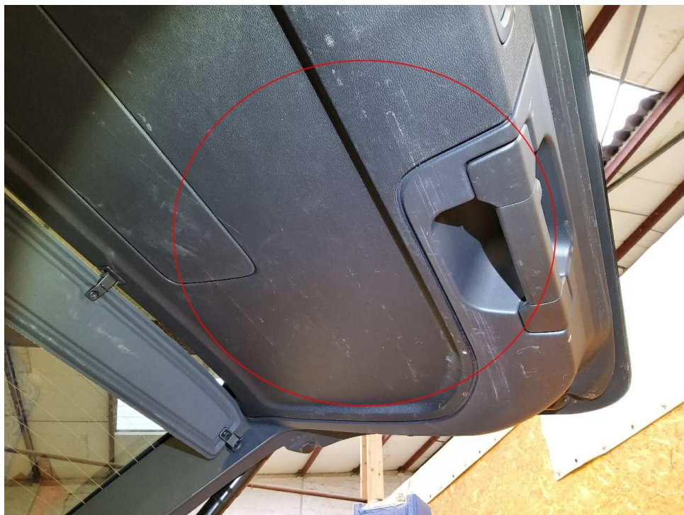
Bild 10 : Verkleidung Heckklappe, zerkratzt
