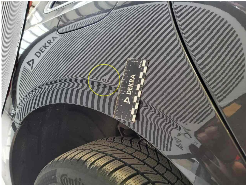
Bild 9 : Seitenteil hinten rechts, eingedellt, Gebrauchsspur
