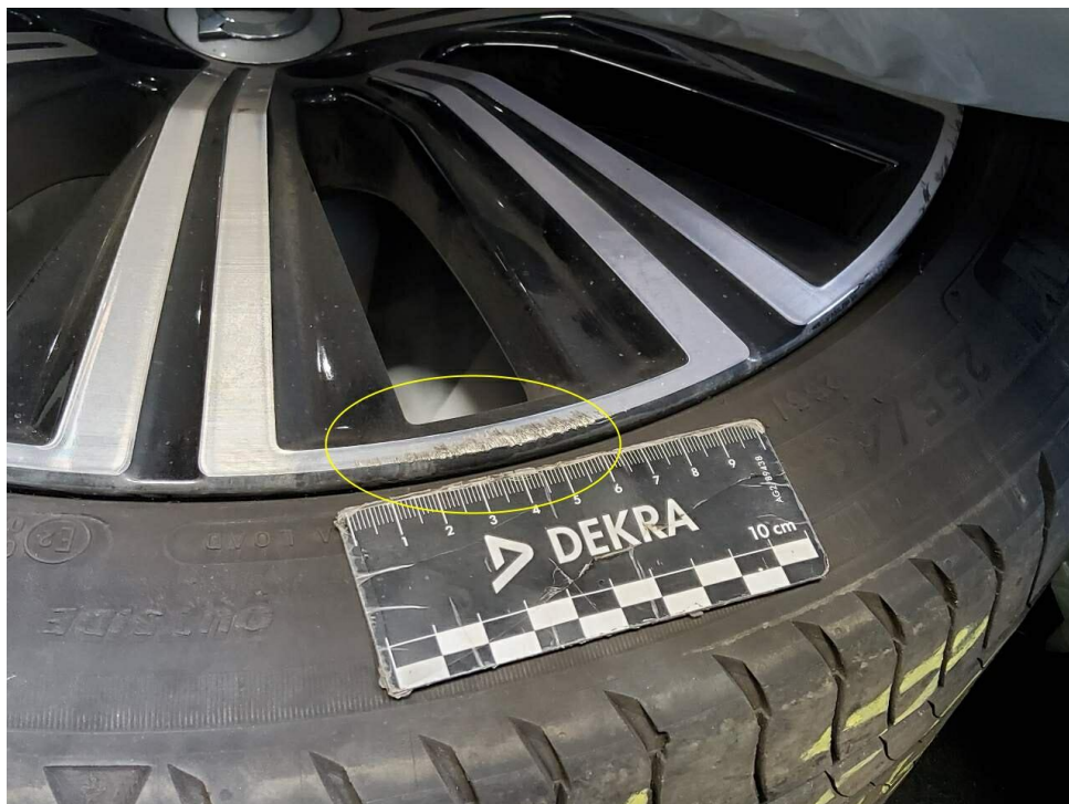
Bild 14 : Felge vorne rechts verschrammt
