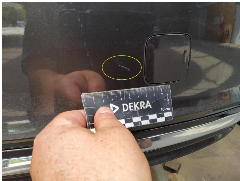
Bild 8 : Stoßfänger hinten Lackierung, zerkratzt, Gebrauchsspur
