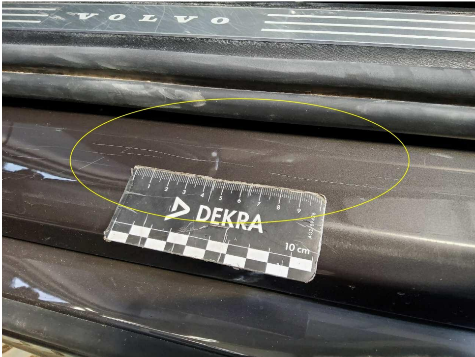
Bild 17 : Einstieg vorne links verschrammt
