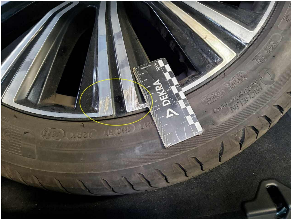
Bild 15 : Felge hinten rechts verschrammt
