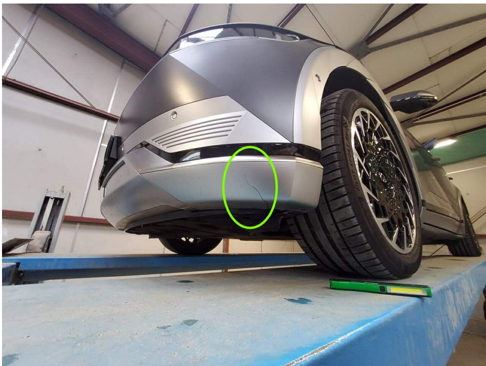
Bild 20 : STOSSF.-ABDECKUNG V.U. gebrochen
