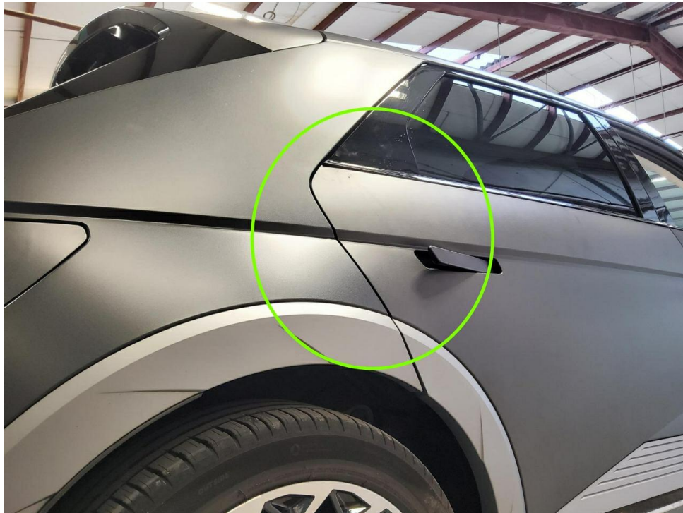
Bild 11 : Tür hinten rechts Lackierung, nicht fachger., Farbton, matt, lackieren
