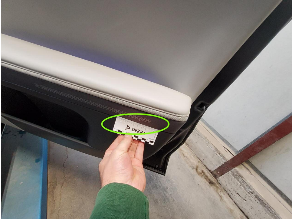
Bild 17 : Türverkleidung vorne rechts Kratzer
