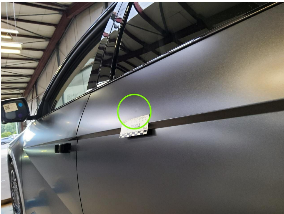
Bild 18 : Tür hinten links Delle
