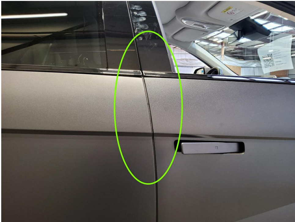
Bild 9 : Tür hinten rechts Lackierung, nicht fachger., Farbton, matt, lackieren
