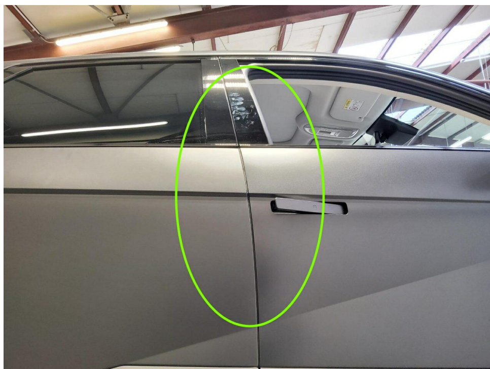
Bild 8 : Tür hinten rechts Lackierung, nicht fachger., Farbton, matt, lackieren
