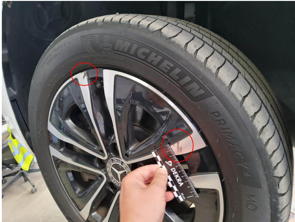
Bild 9 : Felge vorne links, verschrammt, smart repair
