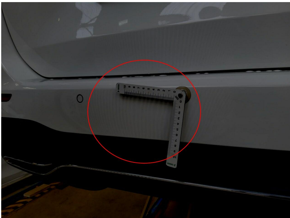
Bild 12 : Stoßfänger hinten, eingedellt, smart repair
