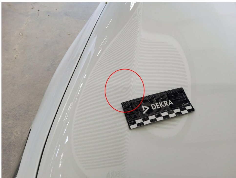
Bild 16 : Motorhaube, mehrfach eingedellt, sanft instandsetzen
