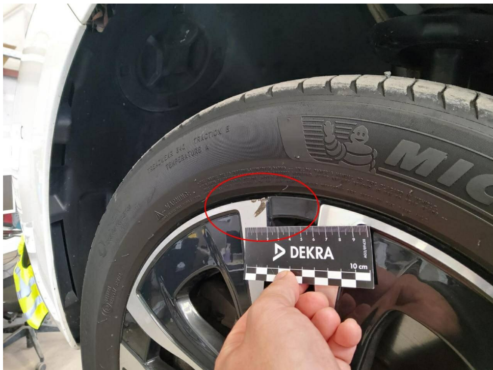
Bild 10 : Felge vorne links, verschrammt, smart repair
