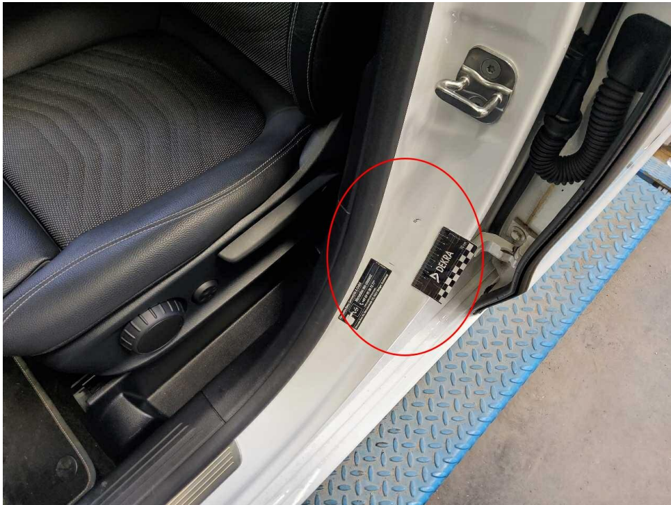
Bild 23 : Einstieg vorne links eingedellt, verschrammt
