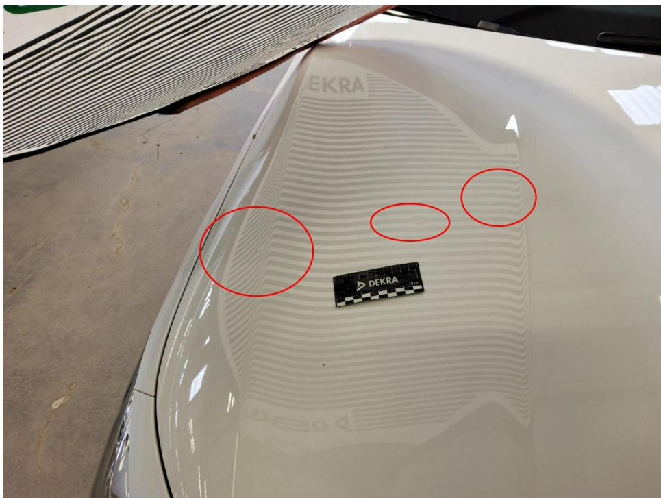
Bild 18 : Motorhaube, mehrfach eingedellt, sanft instandsetzen
