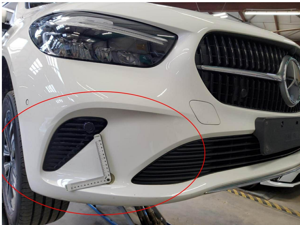
Bild 14 : Stoßfänger vorne Lackierung, Steinschläge > 6 Stück, lackieren mit Lackaufbau
