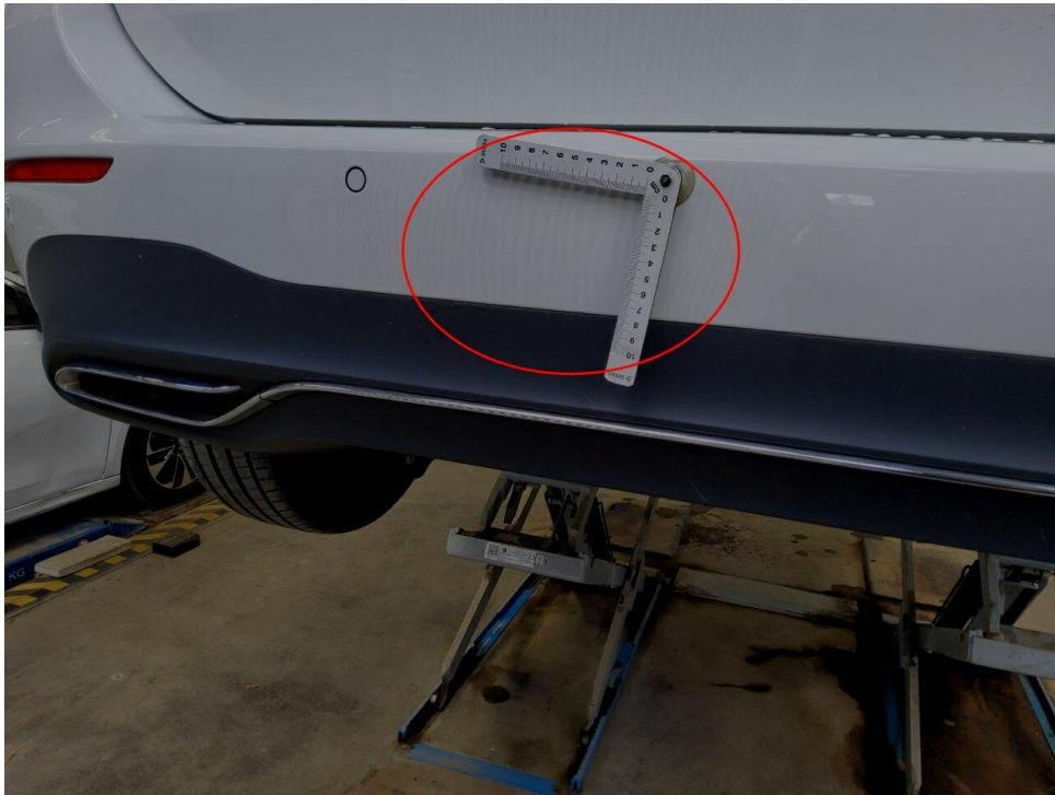
Bild 11 : Stoßfänger hinten, eingedellt, smart repair
