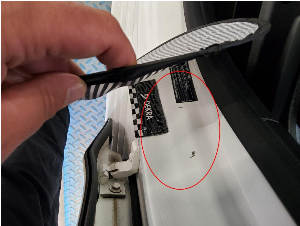
Bild 25 : Einstieg vorne links eingedellt, verschrammt
