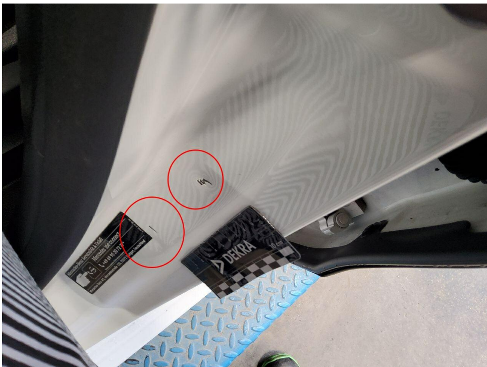
Bild 24 : Einstieg vorne links eingedellt, verschrammt
