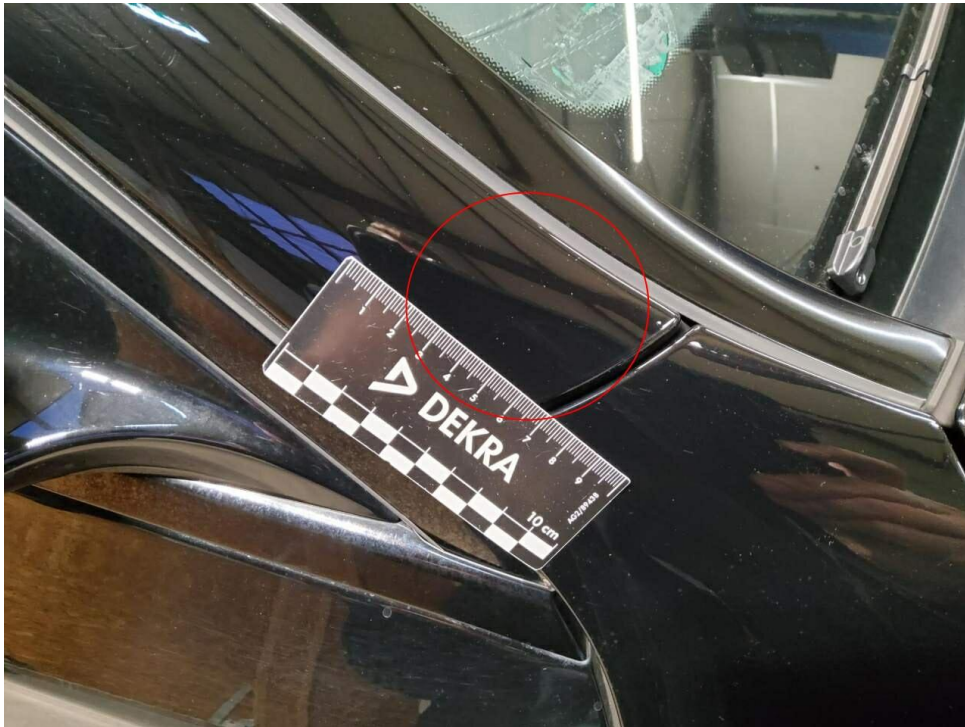
Bild 9 : A-Säule rechts Lackierung, Steinschlag , Gebrauchsspur
