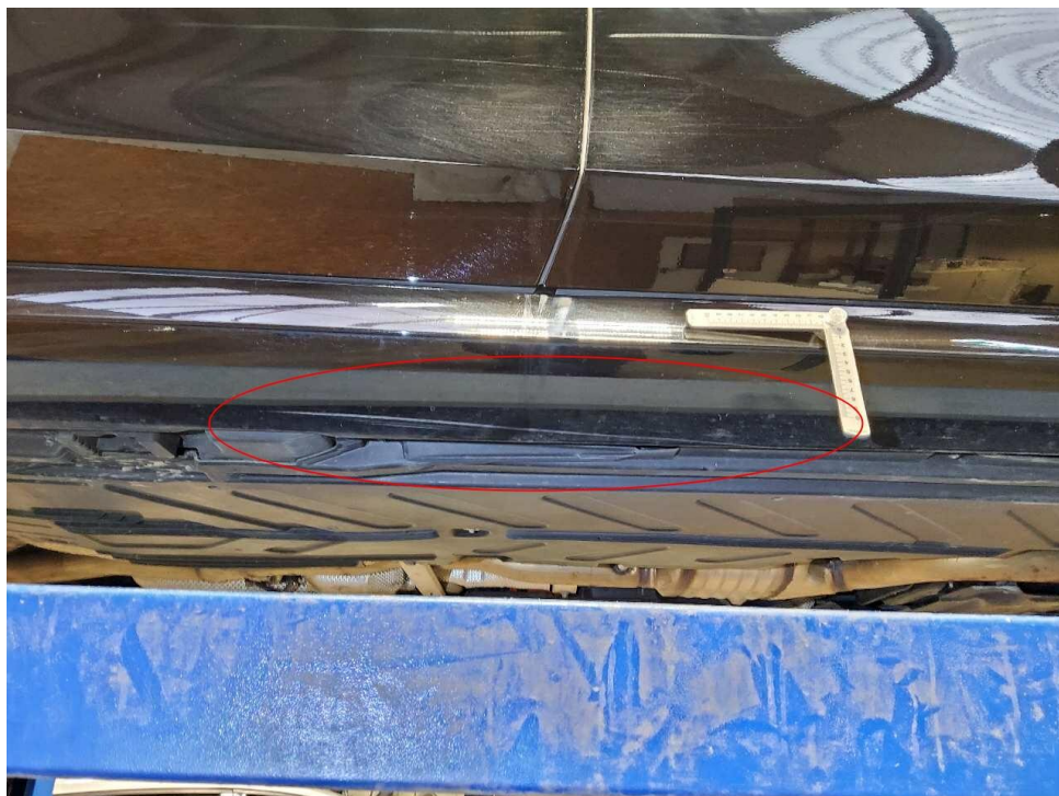
Bild 42 : Seitenschweller rechts Schwellerverkleidung Lackierung, zerkratzt
