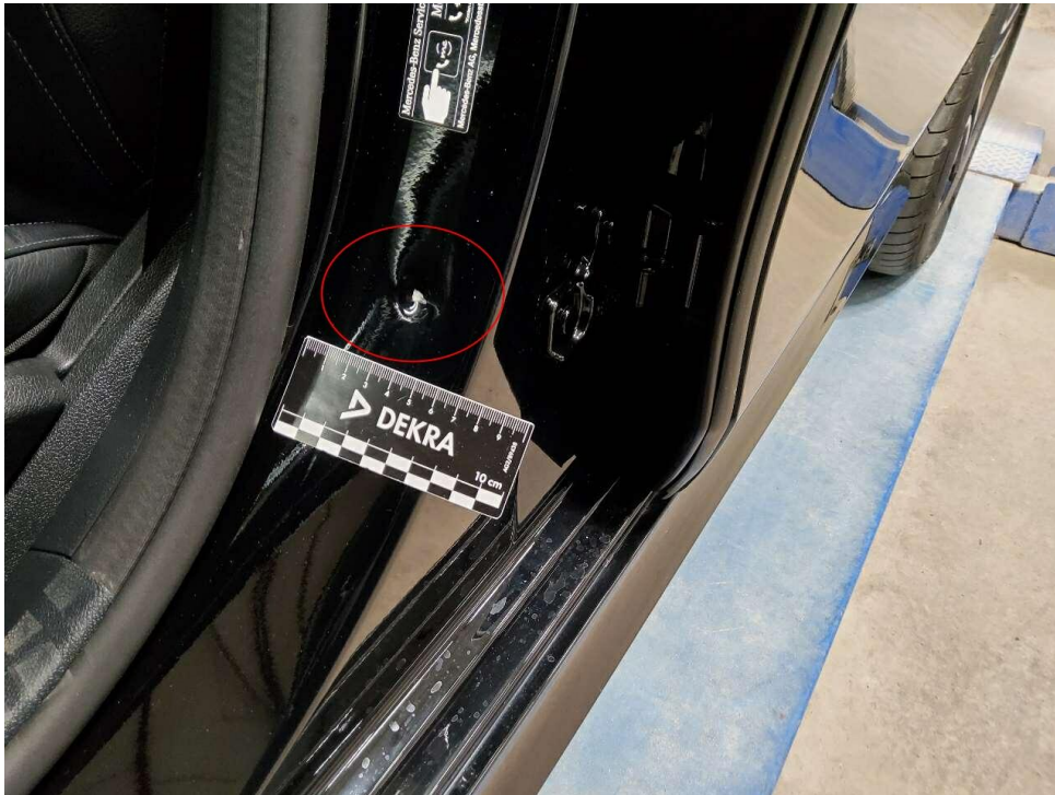
Bild 35 : Tür vorne links Einstieg, zerkratzt und eingedellt
