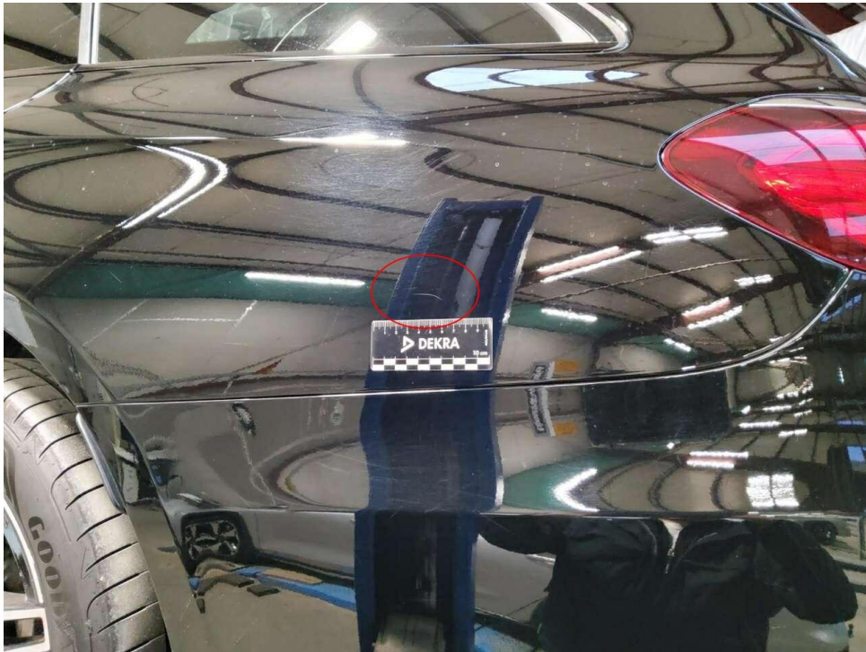
Bild 31 : Seitenteil hinten links Lackierung, zerkratzt, lackieren mit Lackaufbau
