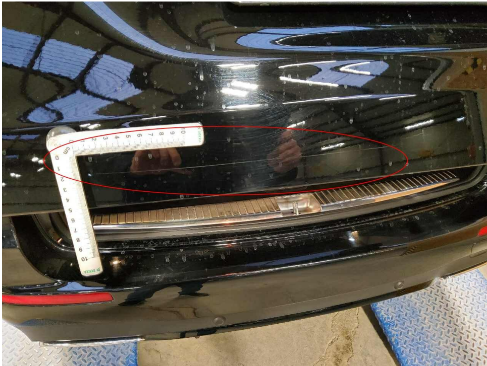
Bild 39 : Heckklappe Lackierung, Oberflächenkratzer
