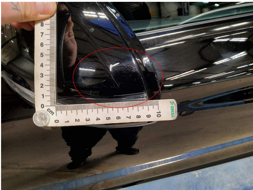
Bild 34 : Außenspiegel links Lackierung, zerkratzt
