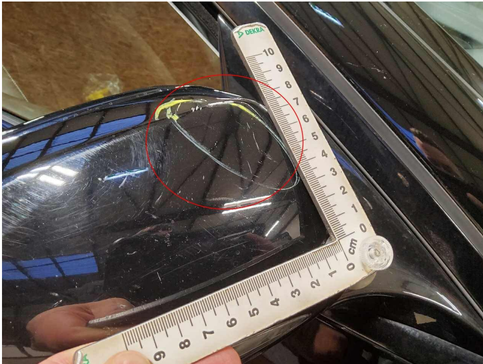
Bild 37 : Außenspiegel rechts Lackierung, zerkratzt
