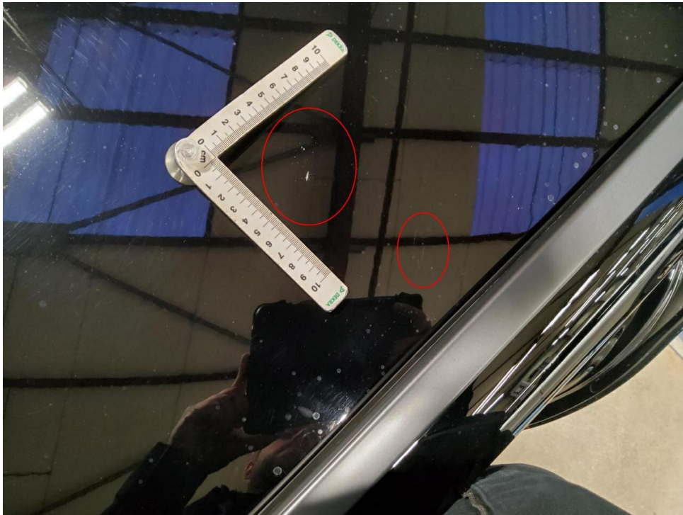
Bild 15 : Dach Lackierung, Steinschlag und zerkratzt , lackieren mit Lackaufbau
