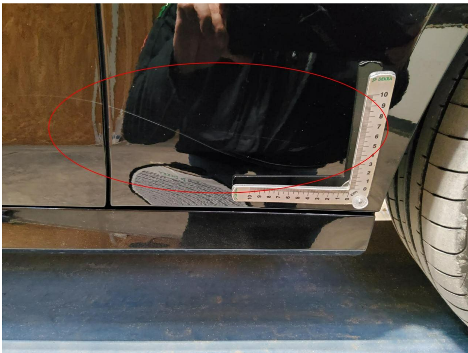
Bild 26 : Kotflügel vorne rechts Lackierung, Steinschlag und zerkratzt , lackieren mit Lackaufbau
