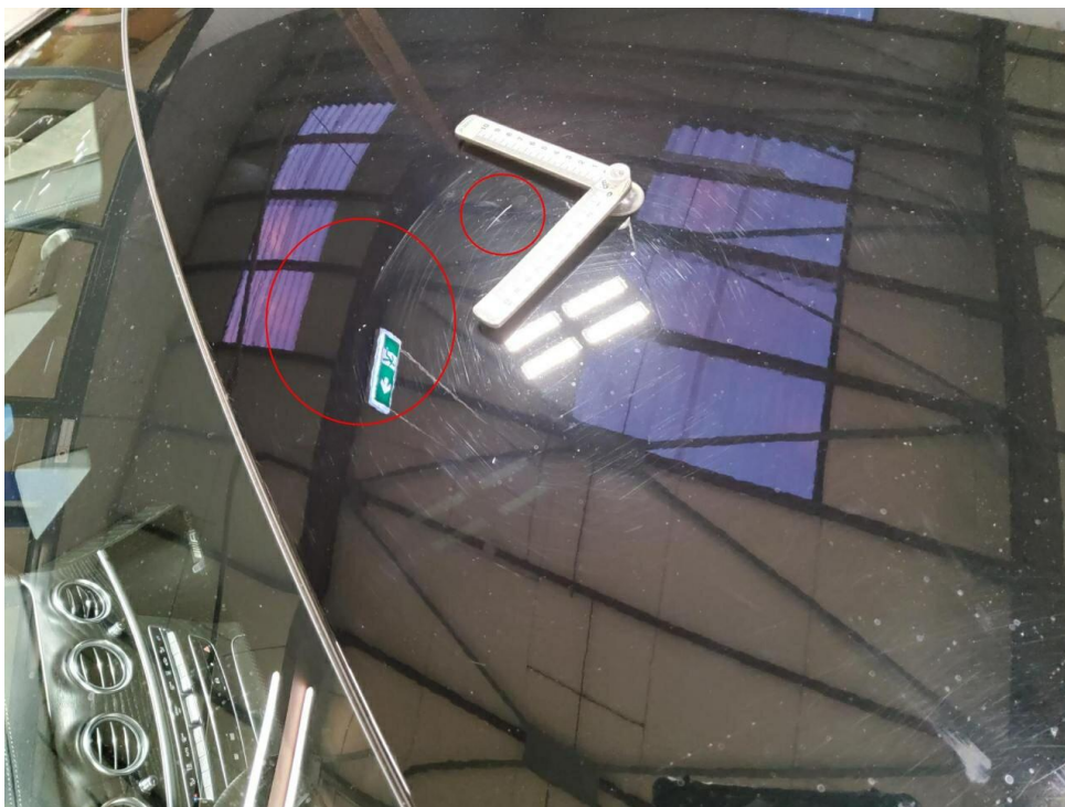
Bild 16 : Dach Lackierung, Steinschlag und zerkratzt , lackieren mit Lackaufbau
