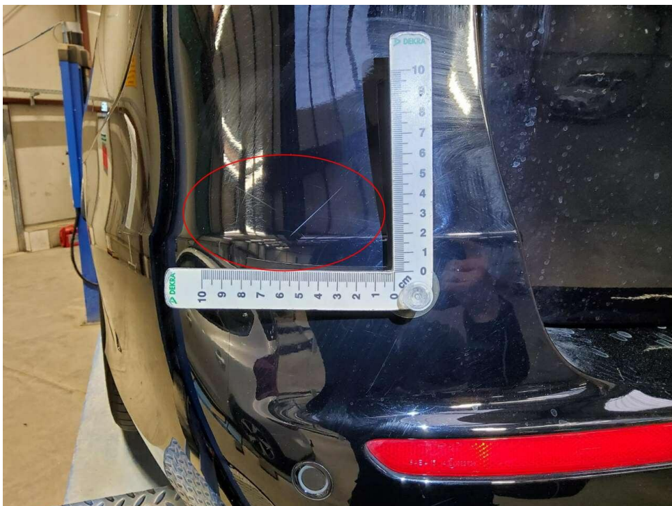
Bild 18 : Stoßfänger hinten Lackierung, zerkratzt, lackieren mit Lackaufbau
