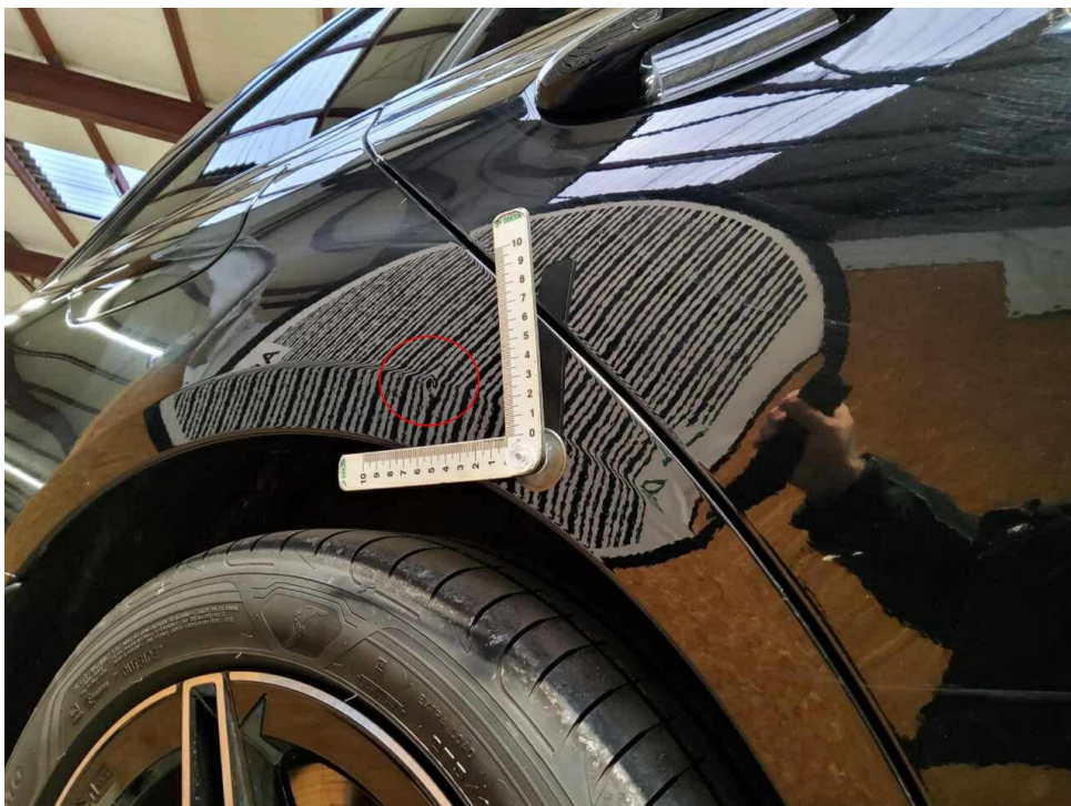
Bild 20 : Seitenteil hinten rechts, zerkratzt und eingedellt , instandsetzen und lackieren mit Lackaufbau
