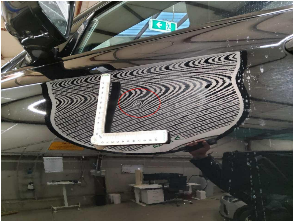
Bild 33 : Tür vorne links, zerkratzt und eingedellt , instandsetzen und lackieren mit Lackaufbau
