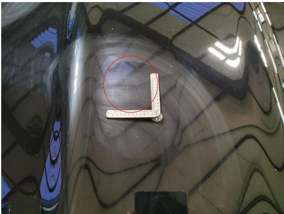
Bild 12 : Motorhaube Lackierung, Steinschlag und zerkratzt , lackieren mit Lackaufbau
