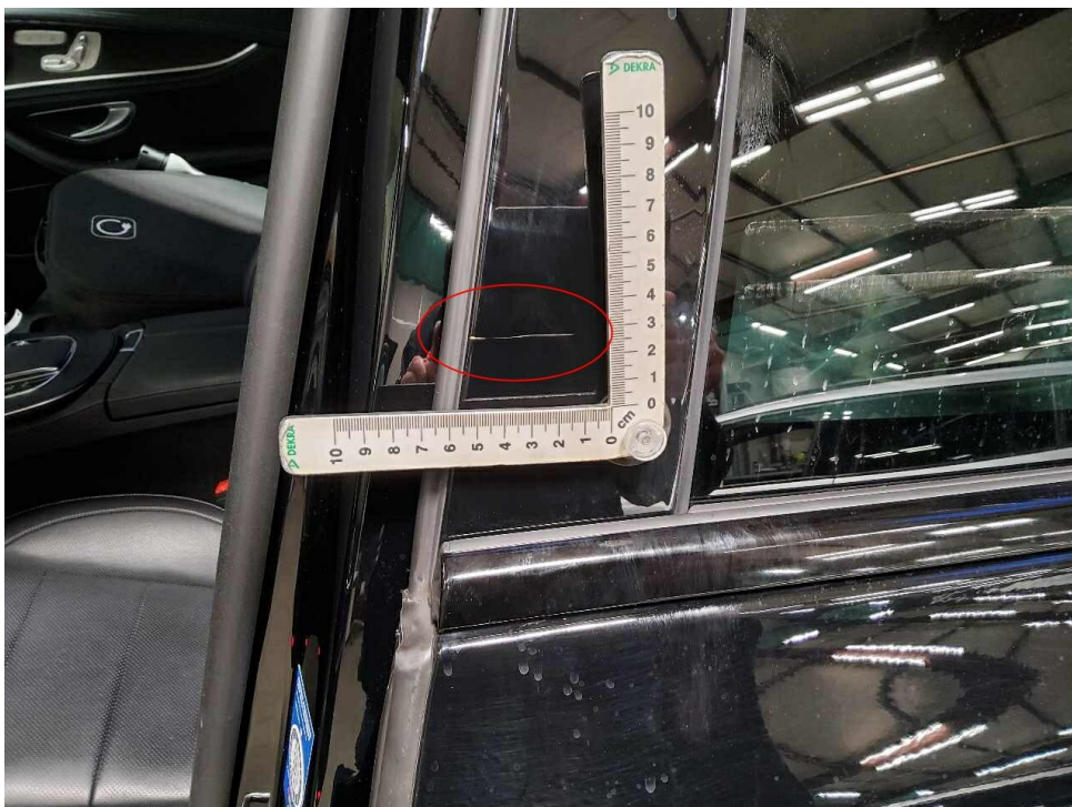
Bild 36 : Tür hinten links Zierleiste Fensterrahmen, zerkratzt
