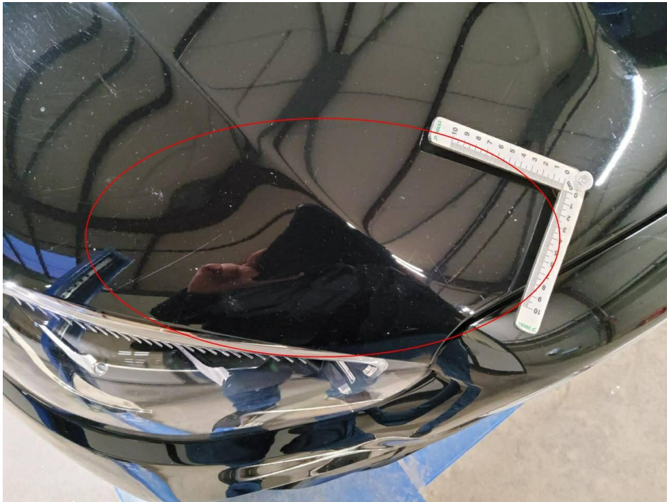
Bild 11 : Motorhaube Lackierung, Steinschlag und zerkratzt , lackieren mit Lackaufbau
