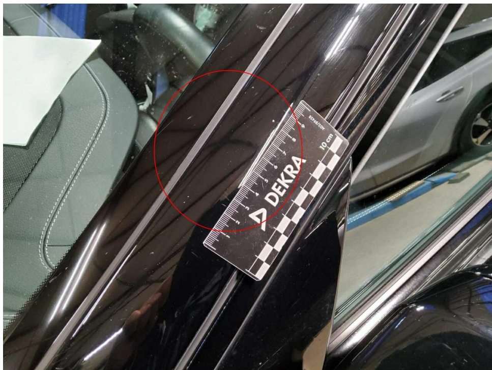
Bild 8 : A-Säule links Lackierung, Steinschlag , Gebrauchsspur
