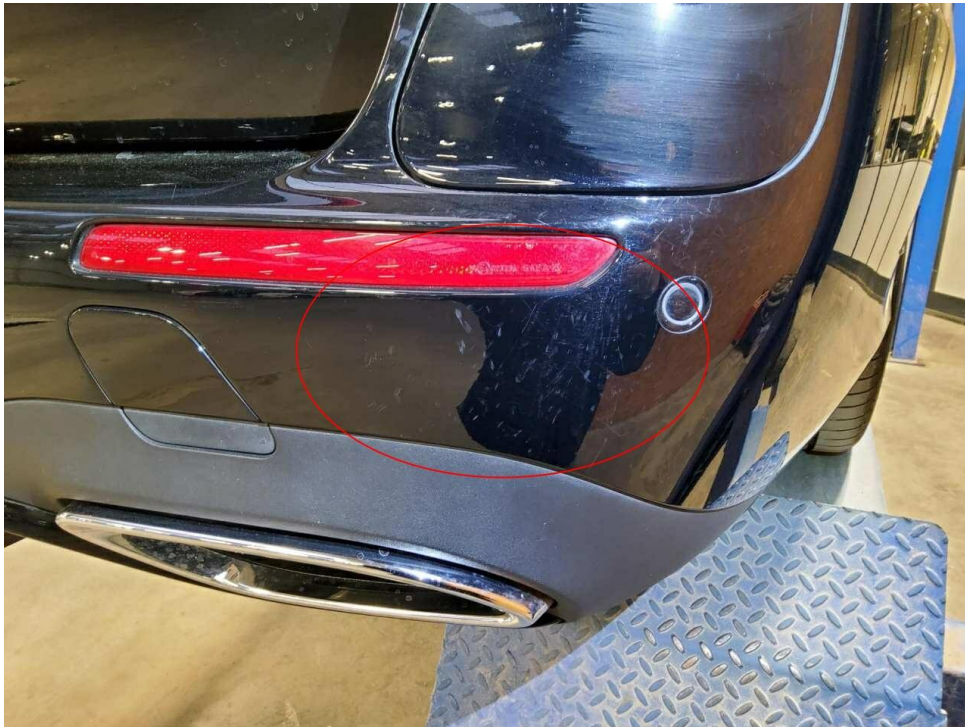
Bild 19 : Stoßfänger hinten Lackierung, zerkratzt, lackieren mit Lackaufbau
