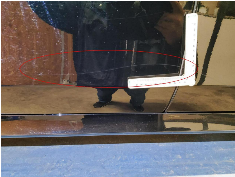
Bild 25 : Tür vorne rechts Lackierung, zerkratzt, lackieren mit Lackaufbau
