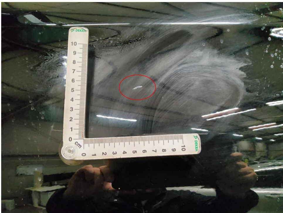
Bild 32 : Tür vorne links, zerkratzt und eingedellt , instandsetzen und lackieren mit Lackaufbau
