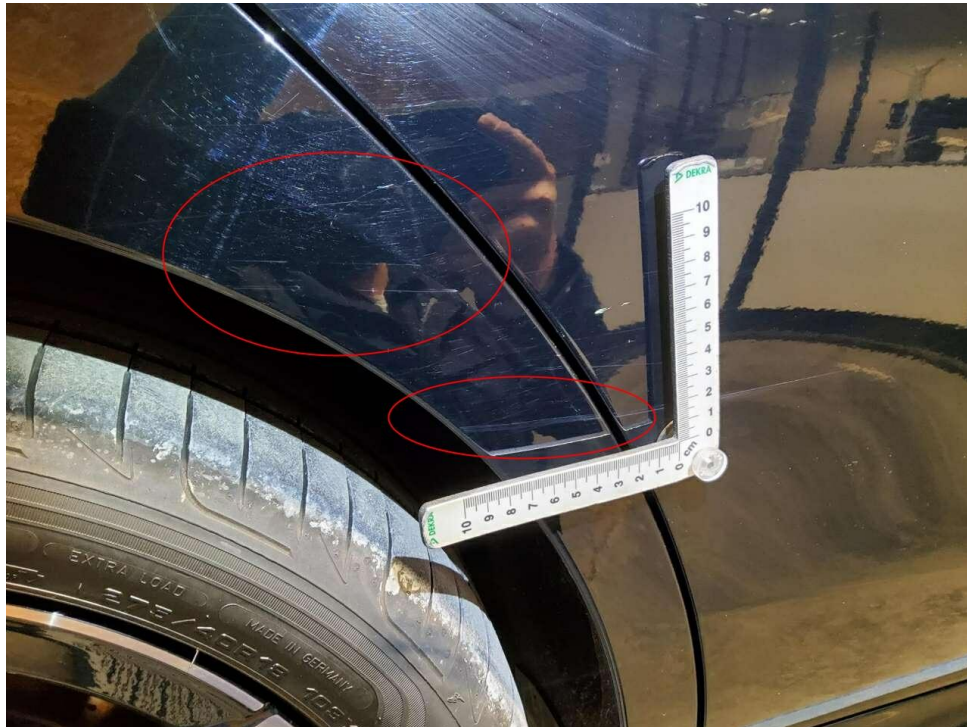
Bild 21 : Seitenteil hinten rechts, zerkratzt und eingedellt , instandsetzen und lackieren mit Lackaufbau
