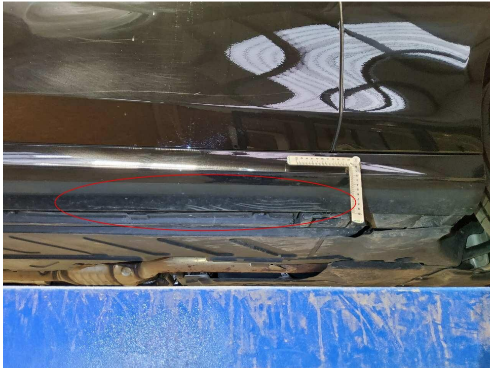
Bild 41 : Seitenschweller rechts Schwellerverkleidung Lackierung, zerkratzt
