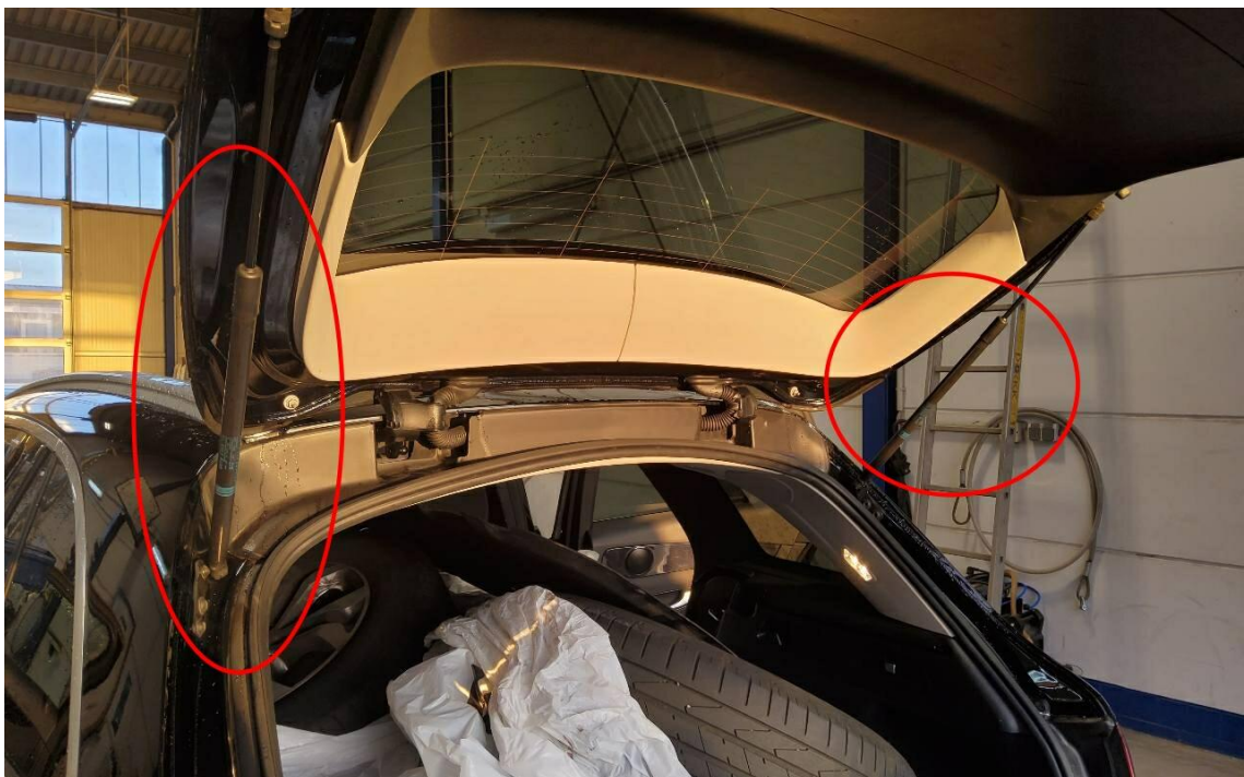
Bild 10 : Heckklappe, Dämpfer defekt (Klappe fällt von alleine zu)
