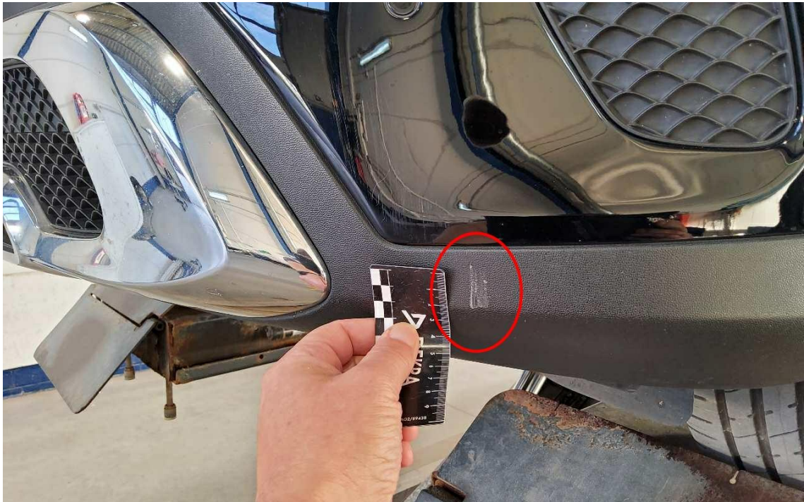
Bild 11 : Stoßfänger vorne, verschrammt, Gebrauchsspur
