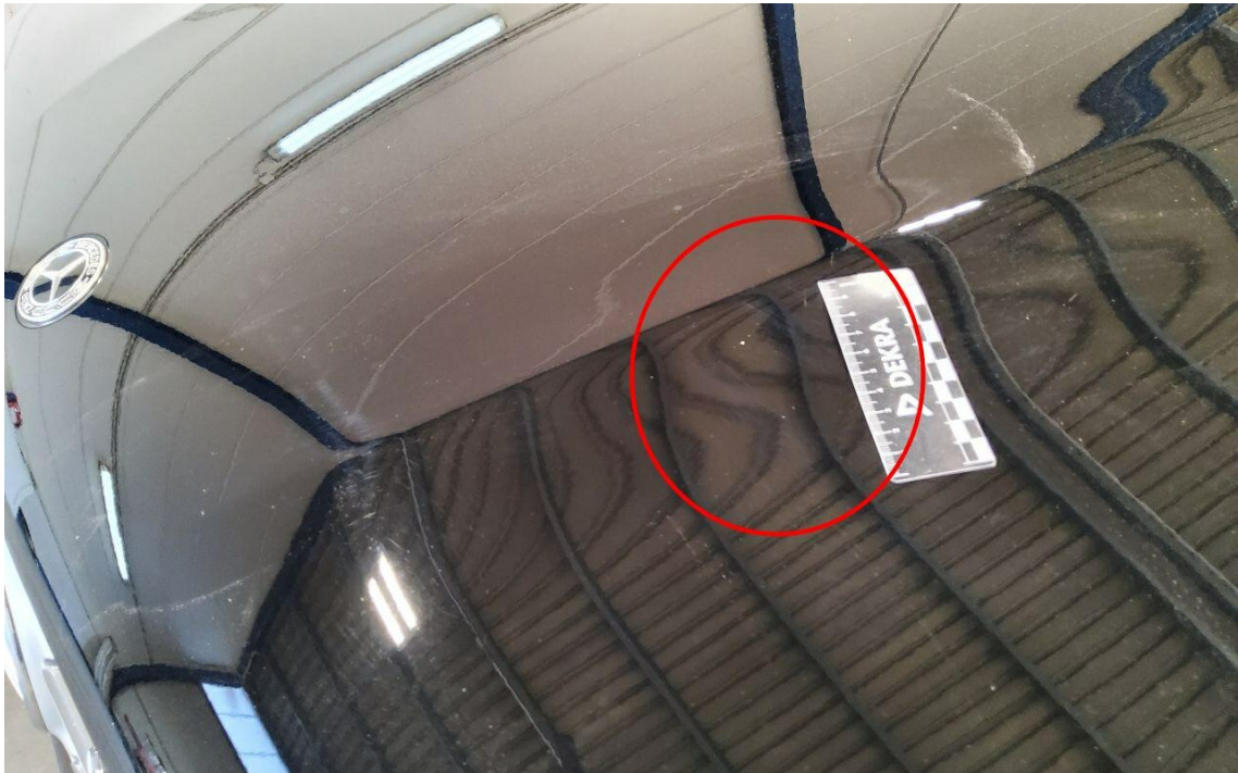
Bild 9 : Leichter Steinschlag im Frontbereich (inkl.Frontscheibe), Gebrauchsspur
