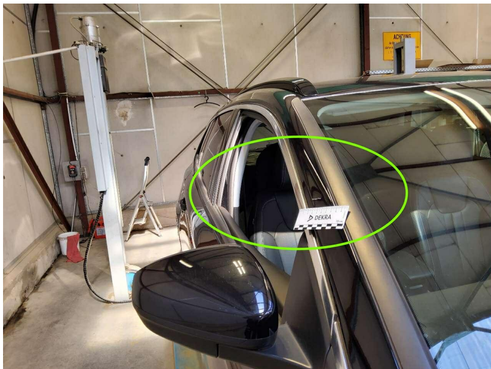
Bild 14 : Dachrahmen rechts Kratzer
