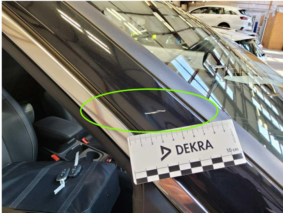
Bild 13 : Dachrahmen rechts Kratzer
