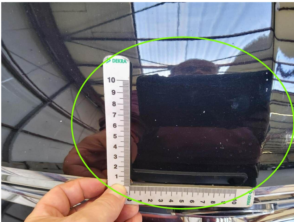
Bild 10 : Motorhaube, Steinschlag >6St. /dm 2 , lackieren mit Lackaufbau
