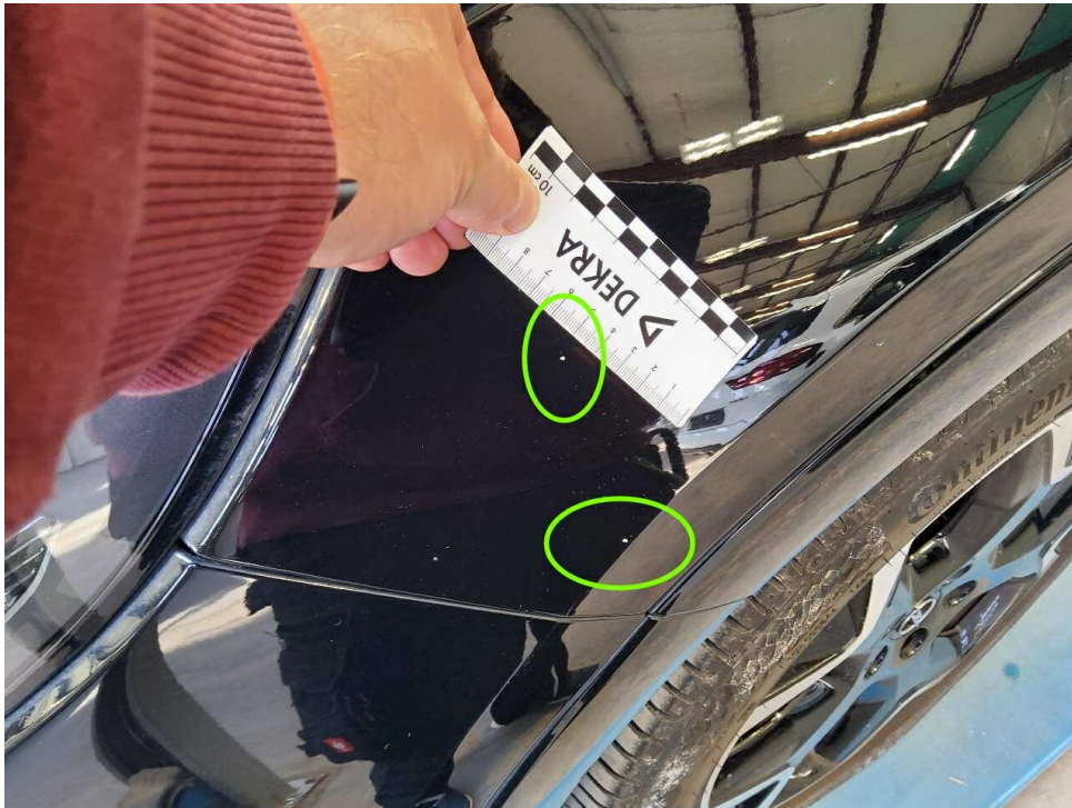
Bild 15 : Kotflügel links Steinschlag
